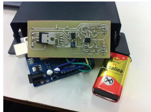
Figura 3. Placa de filtragem e conversão
