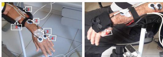
Figura 2: Posicionamento dos sensores: 1 – eletrodo do grupo extensor; 2 – MinIMU 2; 3 – MinIMU 1; 4 – Eletrodo de referência; 5 – eletrodo do grupo flexor; 6 – Peso da mão
