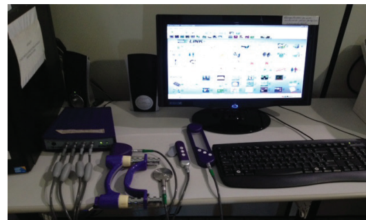
Figura 1. Kit Biometrics® E-link modelo H500
